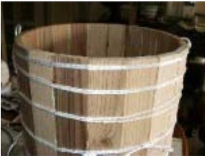
実はこの工程が結構大変。私は板を横に並べて、20 枚の板をテープで 3 箇所固定し、一枚ずつボンドを塗り、塗り終わったら胴を立てて、テープを引っ張って丸くし、写真にあるようなビニールの紐で仮止めし、板の位置をそろえました。急いで作業しないと途中でボンドが乾いてしまいます。
