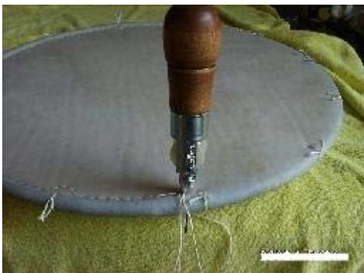
手縫いの始まりです。直接縫い針で縫うのは厳しいので、皮革手縫い用具を使いました。これだと、上・下糸を使います。ワックスをかけた麻糸を針に通して、上からプスッと挿し、手で下糸を通し、針を抜き、これを繰り返します。金輪の所々に見える糸は、後でロープを通す為に予め千枚通しで小さな穴を開け、印に糸で縛りました。革がある程度乾燥したところでポンチで穴を開けます。写真は薄い革です。厚い革は糸を2本使ったのでこの道具で穴だけ開け、縫い針を使って手縫いしました。
